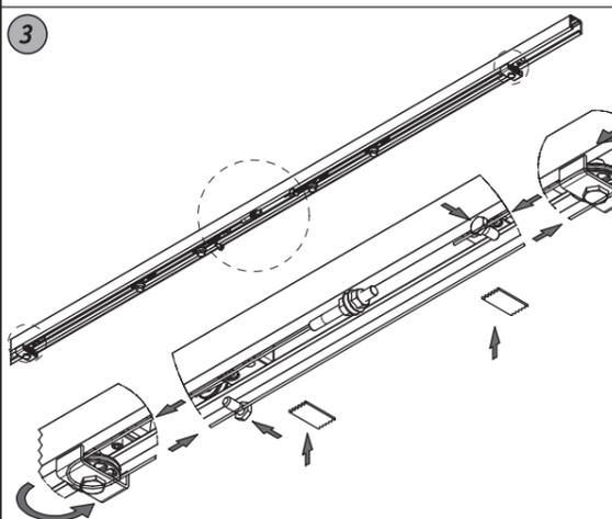
**I** Montare il cavetto facendolo passare intorno alle carrucole e inserire le viti forate sul cavetto, posizionandone una sul tratto anteriore e l'altra sul tratto posteriore. Bloccare momentaneamente le due estremità del cavo al binario con del nastro adesivo.
