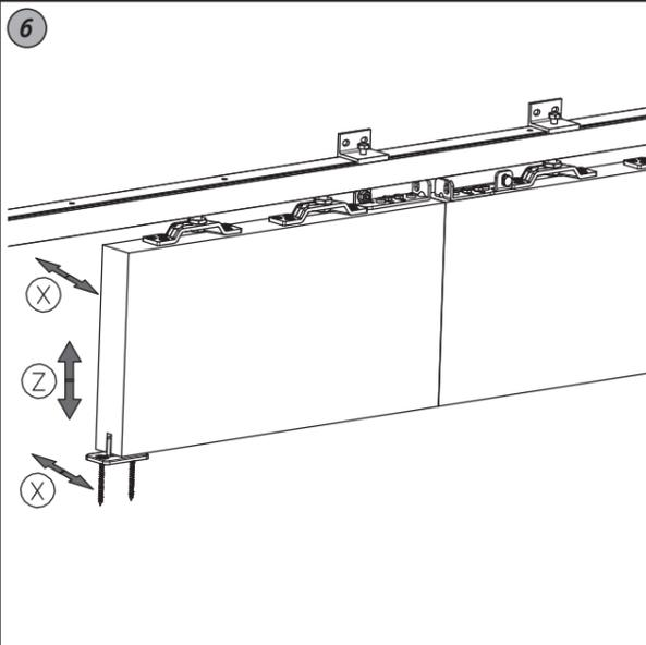
**I** Regolare le ante in altezza allentando i dadi di bloccaggio e agendo sulle viti della staffa. A regolazione ultimata serrare tutti i dadi di bloccaggio. Regolare le ante in profondità allentando i dadi di bloccaggio e spostando le ante lungo l'asse "X". Se necessario, regolare anche i naselli inferiori. A regolazione ultimata serrare tutti i dadi di bloccaggio.
