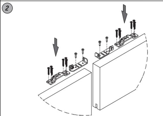
**I** Montare le staffe di fissaggio anta e le staffe di fissaggio fune sul pannello rispettando il verso e le quote indicate.
