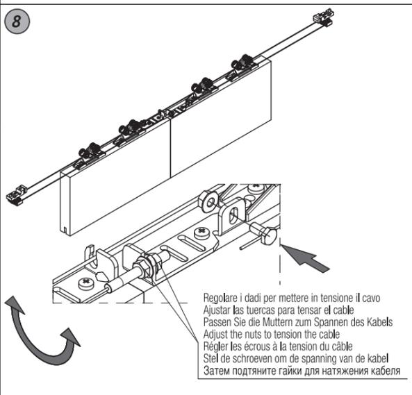
**I** Inserire l'estremità filettata del cavetto nell'asola aperta della staffa di fissaggio fune e fissarla con i rispettivi dadi. Fissare il cavetto alle staffe di fissaggio fune con le viti forate, precedentemente inserite su di esso, e portarlo in tensione agendo sui dadi montati sull'estremità filettata. NB: Tensionare il cavetto fino a quando le due ante si muovono contemporaneamente.
